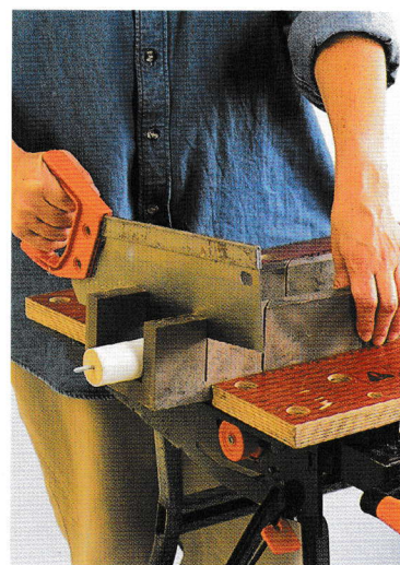
3. Pentru scurtarea unei vergele din lemn, aceasta se blochează într-un ghidaj de tăiere. Șurubul cu filet dublu care fixează capătul vergelei se scoate cu un clește și se reintroduce în noua extremitate a barei.
